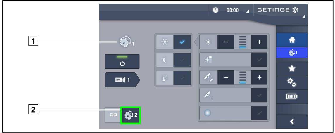
Şek. 60: Lamba başlıklarının senkronize edilmesi
