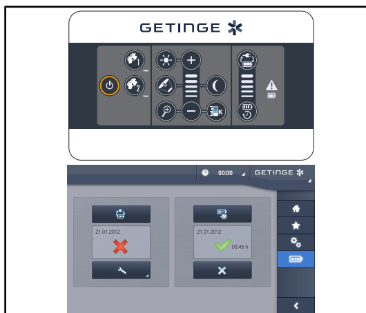
Fig. 51: Test för omkoppling till nödkraft
