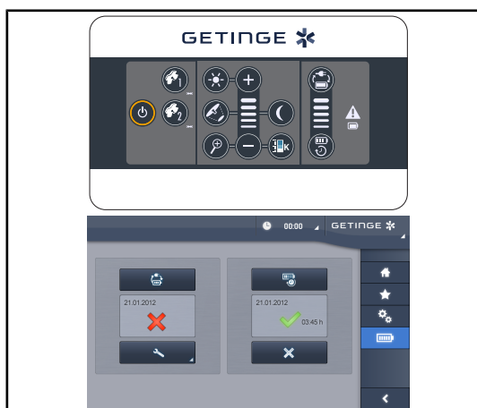
Fig. 51: Test de conmutación a la alimentación de emergencia
