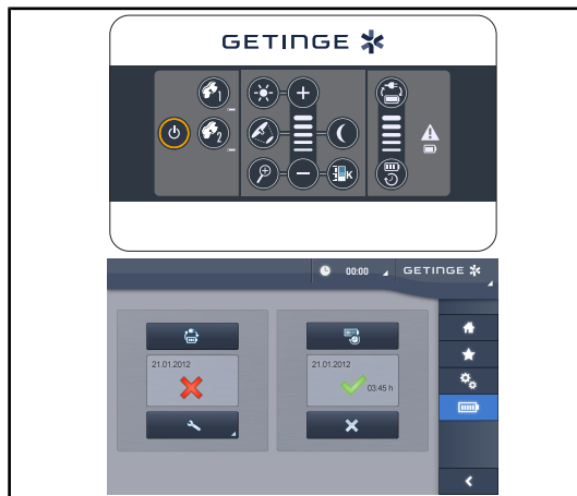
Rys. 51: Test przełączenia na system awaryjny
