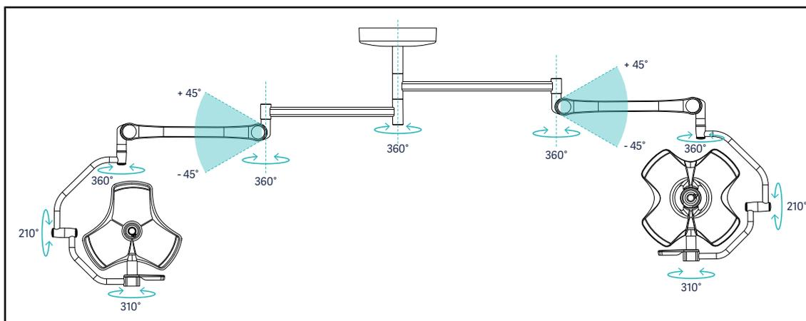
Fig. 78: Mögliche Rotationen bei einer Konfiguration mit zwei Leuchten VCSII64DF am Tragsystem SB
