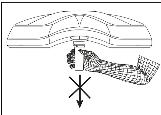
Fig. 41: Halterung für sterilisierbaren Griff
