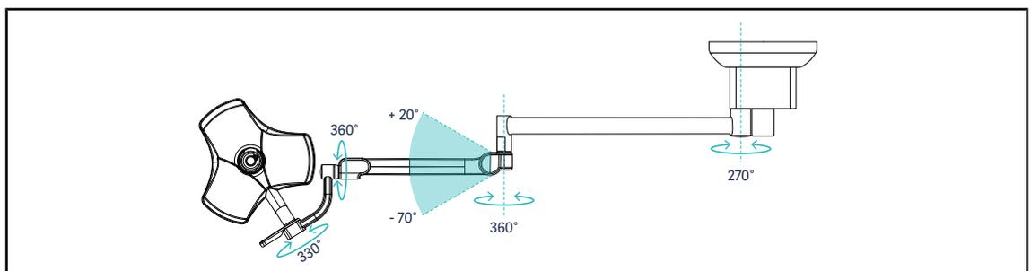
Fig. 77: Mögliche Rotationen bei einer Konfiguration mit einer Leuchte VSTII40SF am Tragsystem SATX
