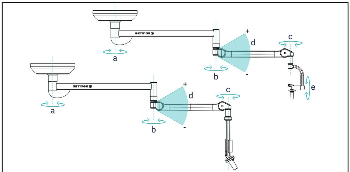
Fig. 110: Rotationswinkel für Kamerahalterungen
