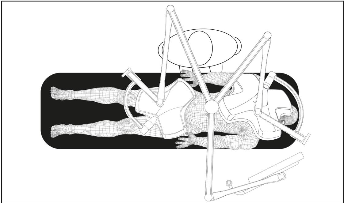
Fig. 106: Beispiel für die Vorab-Positionierung bei Einsatz von zwei Leuchten und einem Bildschirmträger
