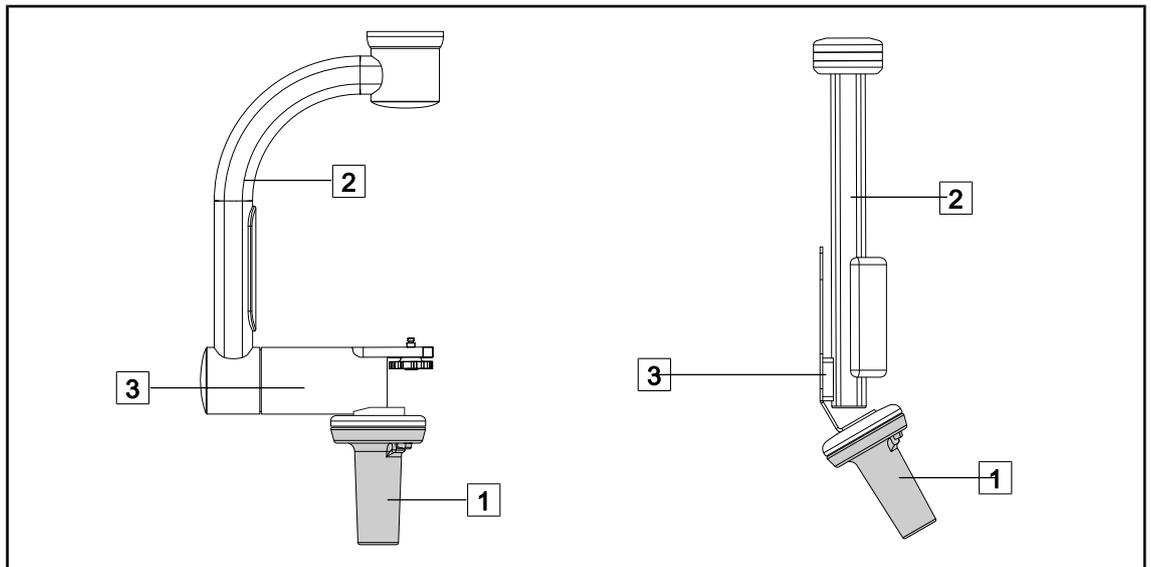
Fig. 109: Verstellen der Kamerahalterung
