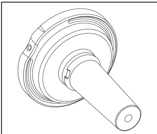
Fig. 22: Halterung für den sterilisierbaren Griff STG PSX
