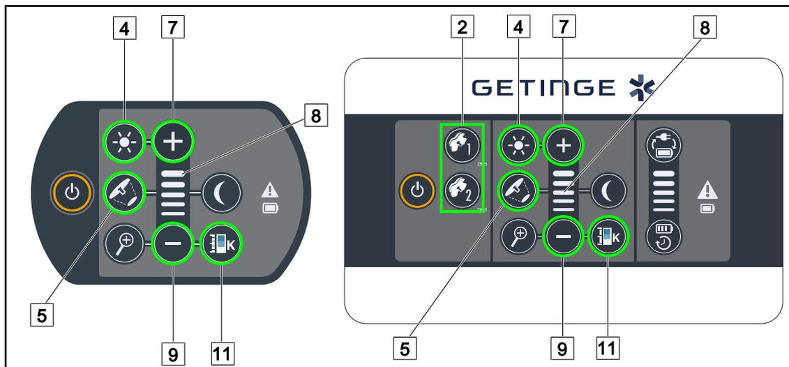
Fig. 54: Einstellen der Beleuchtung über die Bedienfelder
