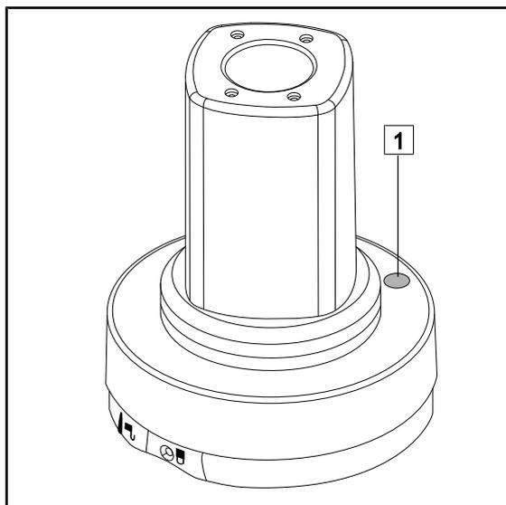
Zur Kopplung einer Kamera mit Funkübertragung bitte die Herstelleranleitung lesen, die dem Funkverbindungssystem beiliegt. Zum Koppelvorgang den Übertragungsknopf der Kamera 1 drücken, um die Erkennung der Kamera bei der Signalsuche zu starten.
