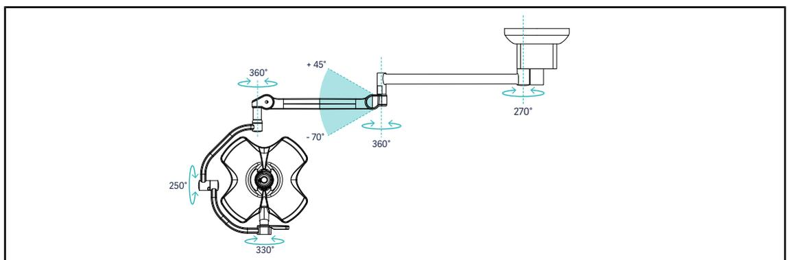
Fig. 76: Mögliche Rotationen bei einer Konfiguration mit einer Leuchte VSTII60DF am Tragsystem SATX
