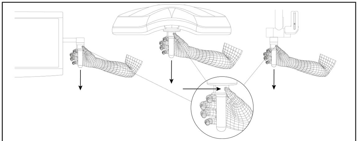
Fig. 68: Entnahme des sterilisierbaren Griffs STG HLX 01
