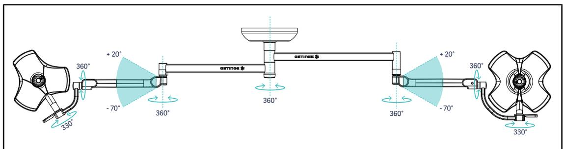
Fig. 75: Mögliche Rotationen bei einer Konfiguration mit zwei Leuchten VSTII64SF am Tragsystem SAX
