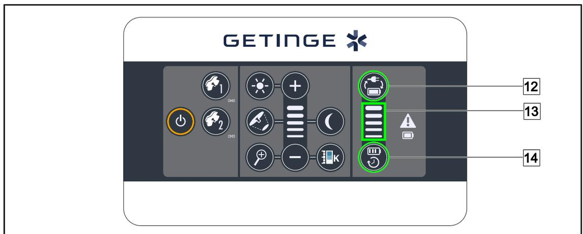
Fig. 120: Akku-Tests über das Wandbedienfeld
