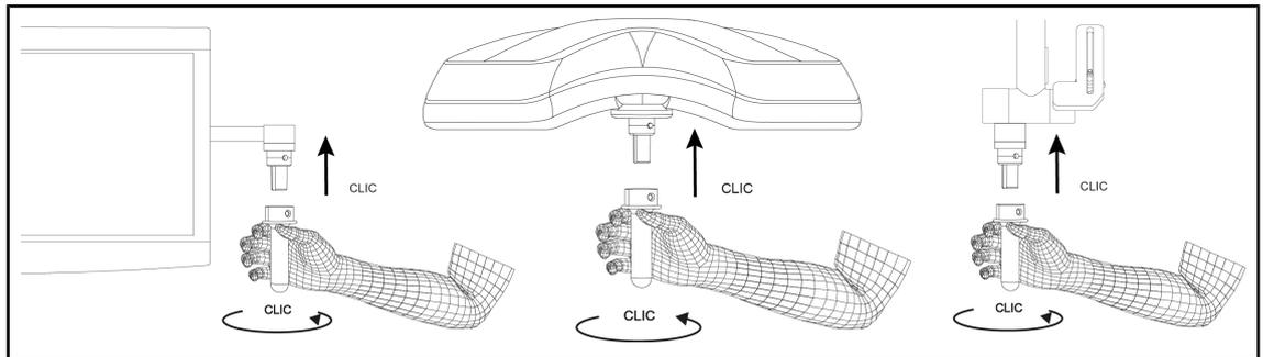
Fig. 67: Anbringen des sterilisierbaren Griffs STG HLX 01
