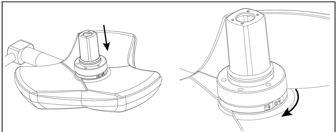
Fig. 88: Montage der Kamera an der Leuchte
