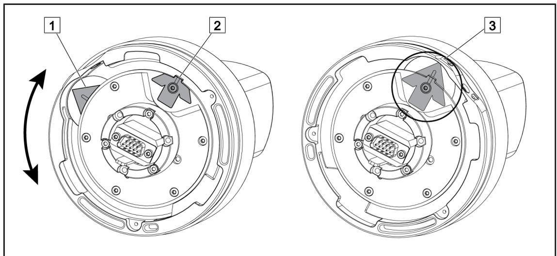
Fig. 84: Voreinstellung der Quick-Lock-Kamera
