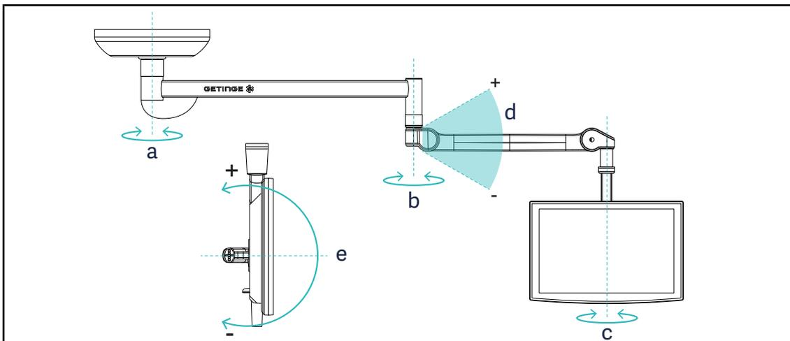
Fig. 104: Rotationsmöglichkeiten bei einem Tragsystem SAX
