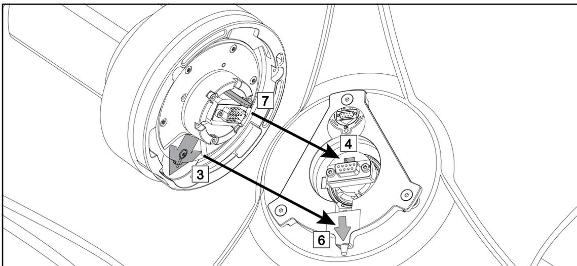
Fig. 87: Darstellung zur Anbringung der Quick-Lock-Kamera
