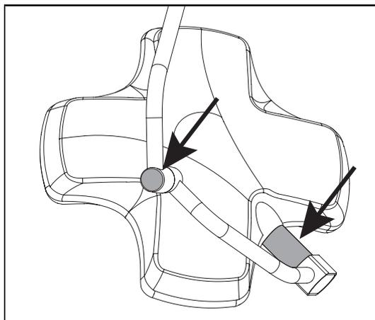
Fig. 46: Unversehrtheit der Achsenmuffe der Leuchte und der Bügelkappe
