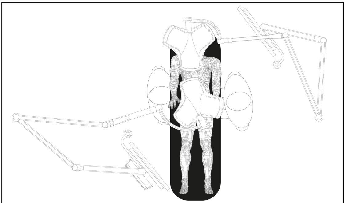
Fig. 107: Beispiel für die Vorab-Positionierung bei Einsatz von zwei Konfigurationen mit je zwei Leuchten und einem Bildschirmträger
