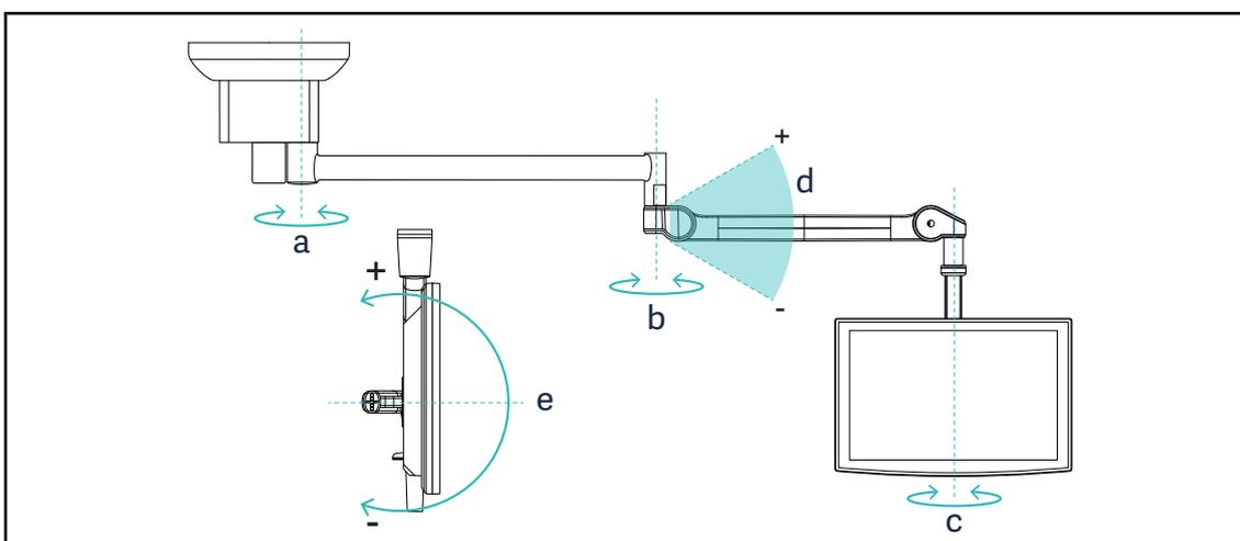
Fig. 105: Rotationsmöglichkeiten bei einem Tragsystem SATX
