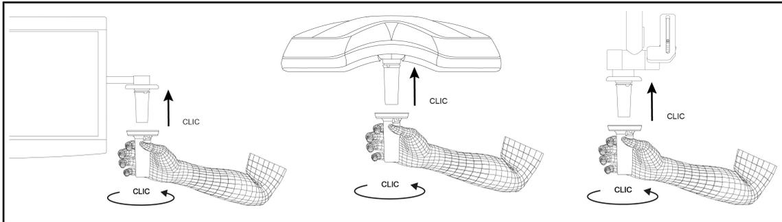
Fig. 65: Anbringen des sterilisierbaren Griffs STG PSX 01
