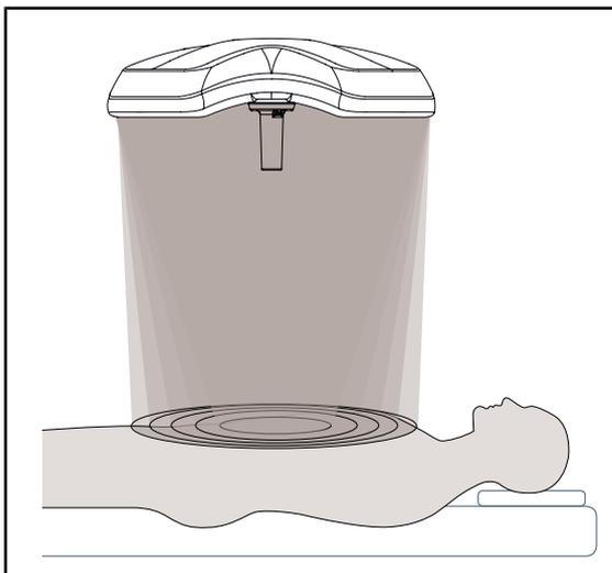
Fig. 5: Einstellbarer Leuchtfelddurchmesser
