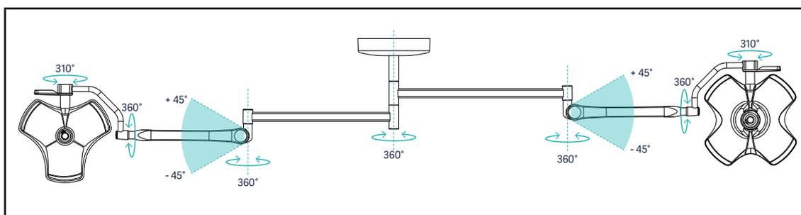
Fig. 79: Mögliche Rotationen bei einer Konfiguration mit zwei Leuchten VCSII64SF am Tragsystem SB
