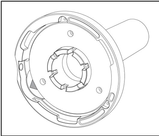
Fig. 91: Quick-Lock-Griffhalterung
