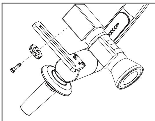
Fig. 108: Anbringung der Kamera an der Halterung SC
