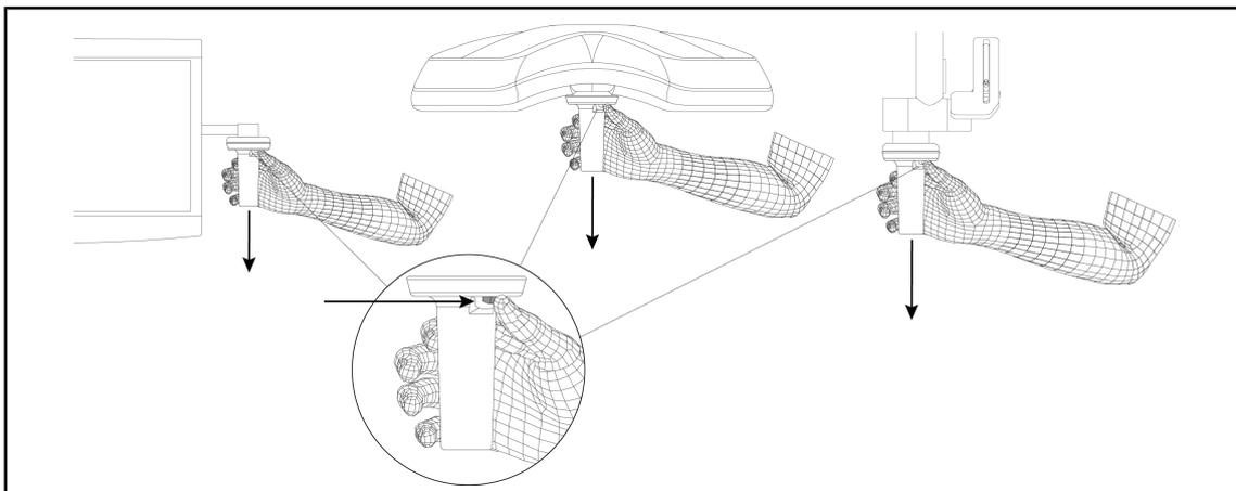
Fig. 66: Entnahme des sterilisierbaren Griffs STG PSX 01
