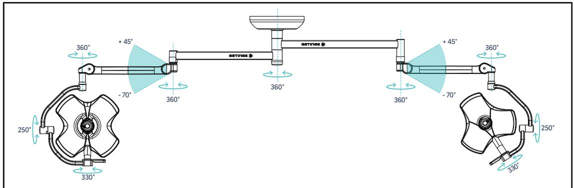
Fig. 74: Mögliche Rotationen bei einer Konfiguration mit zwei Leuchten VSTII64DF am Tragsystem SAX
