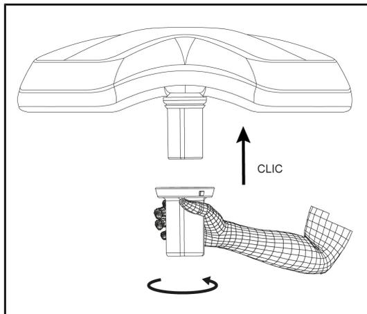
Fig. 71: Anbringen des sterilisierbaren Griffs STG PSX VZ 01
