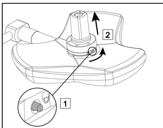
Fig. 90: Entnahme der Kamera von der Leuchte
