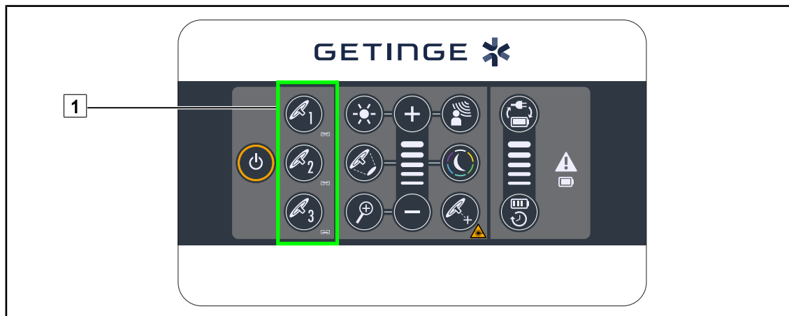
Fig. 59: Leuchtensynchronisation über das Wandbedienfeld
