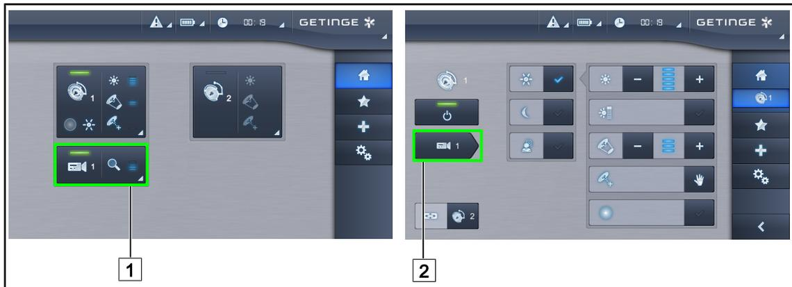
Fig. 24: Einschalten der Kamera über den Touchscreen
