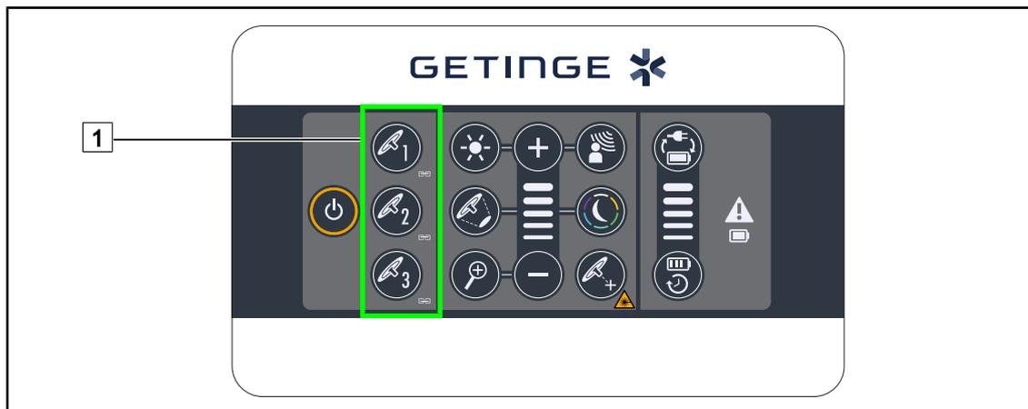
Fig. 59 : Synchronisation des coupoles via le clavier mural
