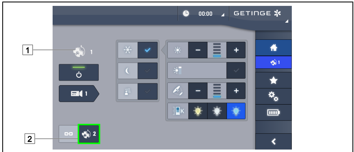
Fig. 61: De lamphuizen synchroniseren
