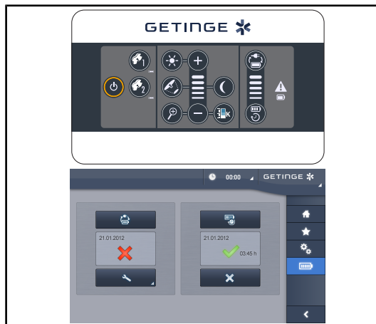
Fig. 51: Test overschakeling noodvoeding
