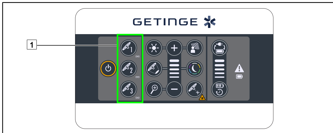
Fig. 59: Synchronisatie van de lamphuizen via het bedieningspaneel op de wand
