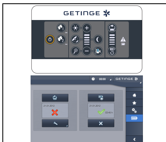
Fig. 51: Test af overgang til nødstrøm
