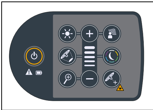
34 pav. Šviestuvo valdymo bloko būklė
