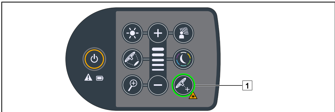
그림 65: 키보드를 통한 레이저 포지셔닝 보조 장치 활성화
