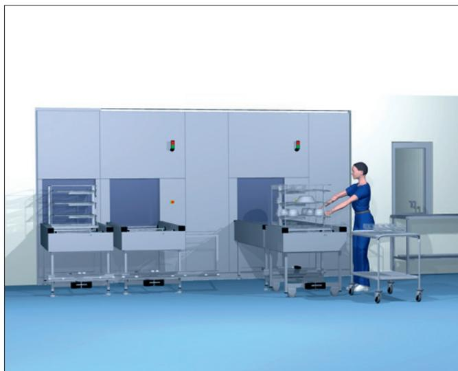
2台のCM 320シリーズと横方向へ動く搬送システムを組み合わせることで、アンローディングが簡単になります。清潔・組立包装エリア
