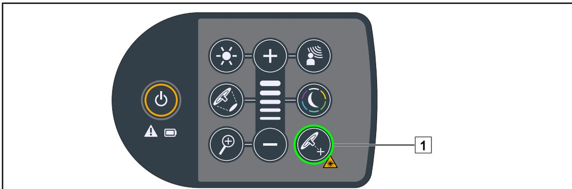
Fig. 65: Einschalten des Lasers zur Leuchtenpositionierung über die Bedienfelder
