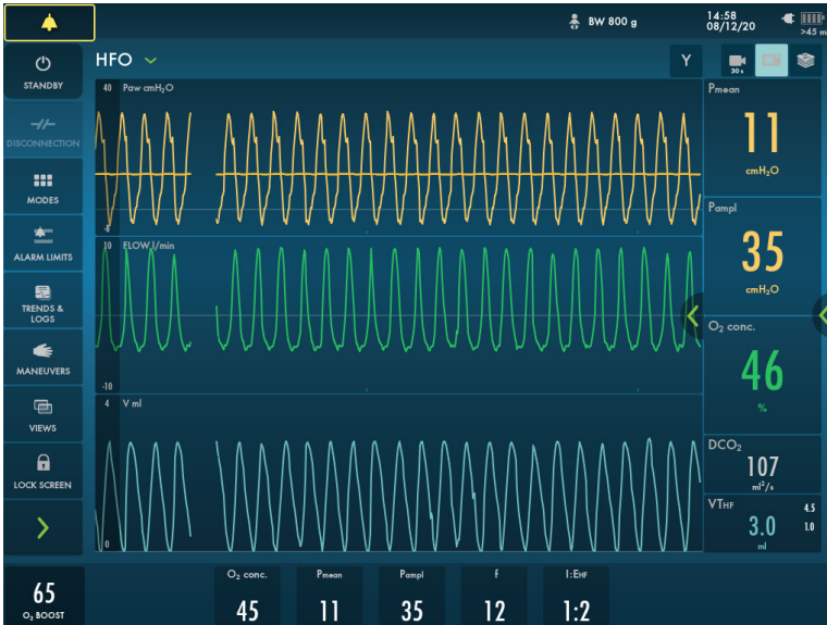
Hochfrequenz-Oszillationsmodus (HFO), Druckamplitudensteuerung.
