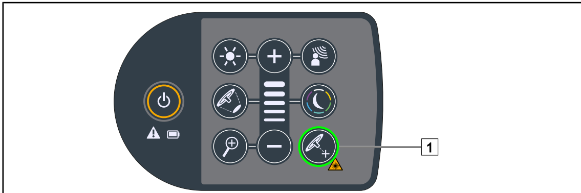
Kuva 65: Asemoinnin apuna käytettävän laser-toiminnon aktivointi ohjauspaneeleista.
