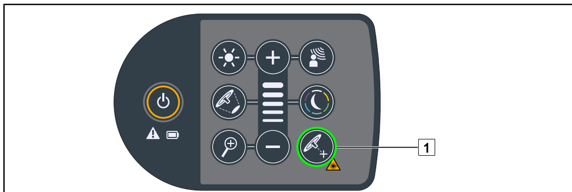
Fig. 65: Inschakeling van de laser als hulp voor de positionering via de toetsenborden
